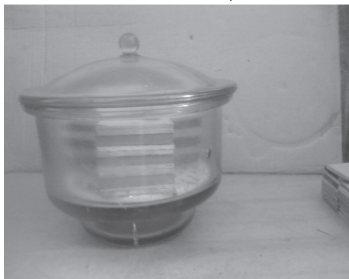
Рис.1. Розташування зразків у гігроскопічних чохлах, розміщених в ексікаторі, зарядженому водою
