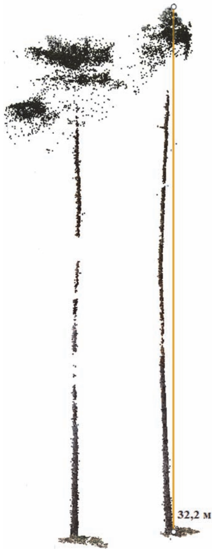
Рис. 1. Вимірювання висоти із хмари точок (спосіб РС)
