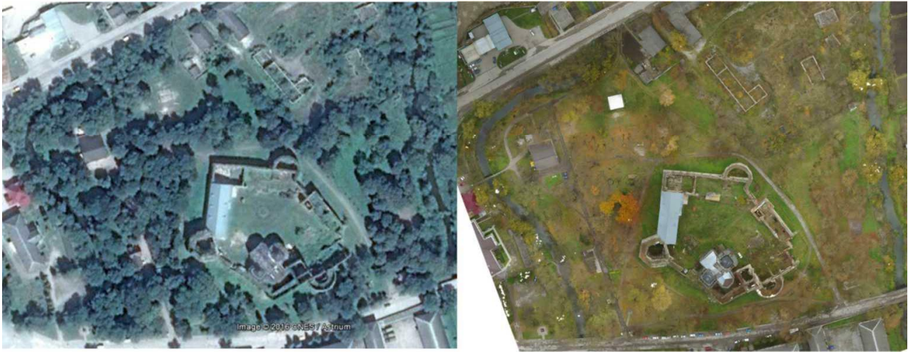
Рис. 3. Порівняння матеріалів ДЗЗ (зліва) з БПЛА ортофотопланом
