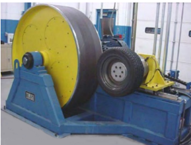
Рис. 2. Загальний вигляд стенду з біговими барабанами, призначеного для проведення лабораторних досліджень процесу кочення колеса.
