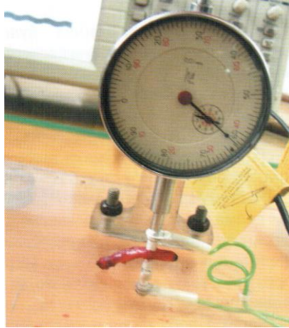
Рис.1. Випробування на міцність, електрозварний шов витримує тиск води 625 мм р. ст.
