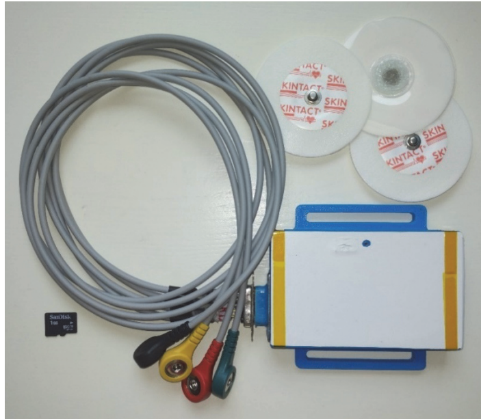
Рис. 2. Прилад для реєстрації ЕКГ з чотирма кабелями для електродів та картою пам'яті, розроблений разом з фахівцями Київського політехнічного інституту ім. Ігоря Сікорського, а також самоадгезивні електроди.
