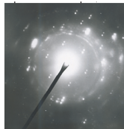
Рис. 4. Електронна дифракція від зразків спінінгованих стрічок \text{Fe}_{63}\text{Mo}_{37}
