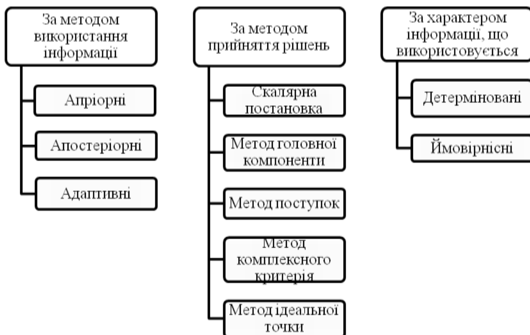
Рис. 1. Структура процедур вирішення багатокритеріальних задач
