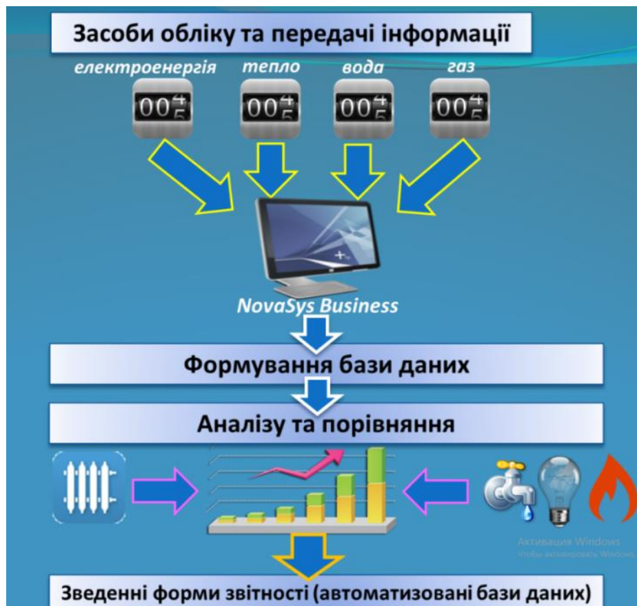
Рис. 2. Структурна схема диспетчеризації системи обліку енергоресурсів
