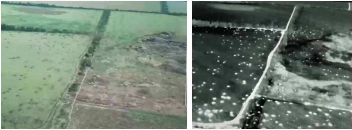
Рис. 4 Знімки поля із воронками від вибухів мін та снарядів у видимому та тепловізійному діапазонах спектру ліворуч та праворуч, відповідно
