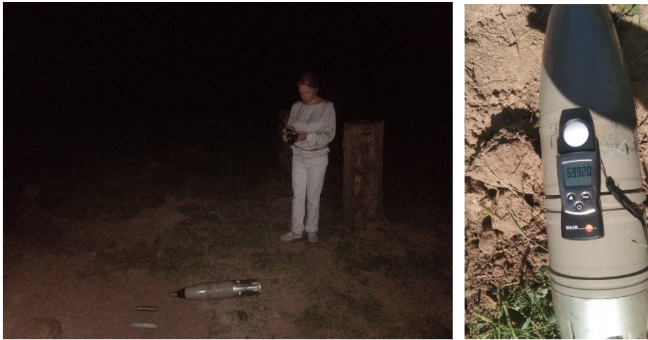
Рис. 2 Проведення тепловізійних досліджень о 22 годині (ліворуч) виміри сонячного випромінювання о 12 годині (праворуч)
