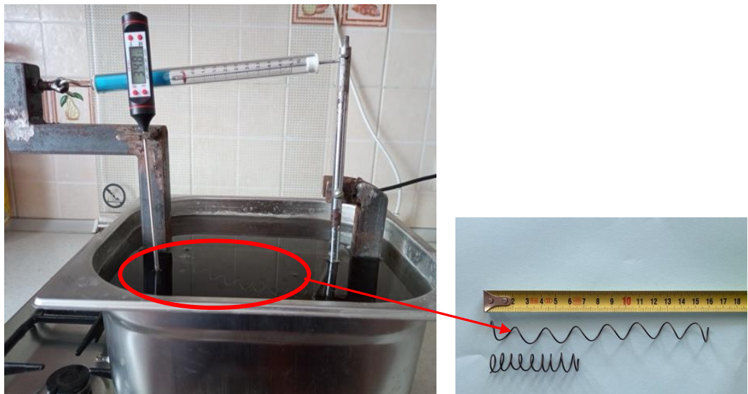
Рис. 3. Загальний вигляд дослідної установки для зняття термомеханічних характеристик пружин [10]
