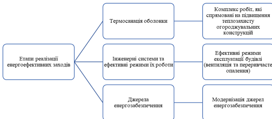
Рис. 2. Блок-схема реалізації енергоефективних заходів в будівлях
