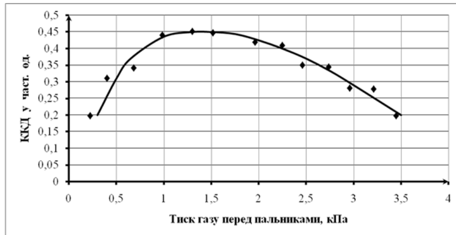
Рис. 2. Залежність коефіцієнту корисної дії (ККД) газової плити від тиску газу перед пальниками
