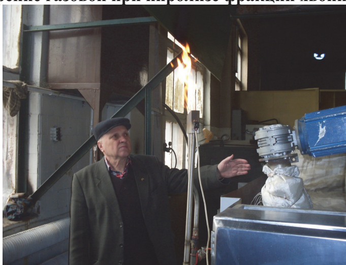
Рис. 2. Горение газовой при пиролизе фракции хвойных опилок
