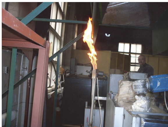
Рис. 2. Горение газовой при пиролизе фракции хвойных опилок
