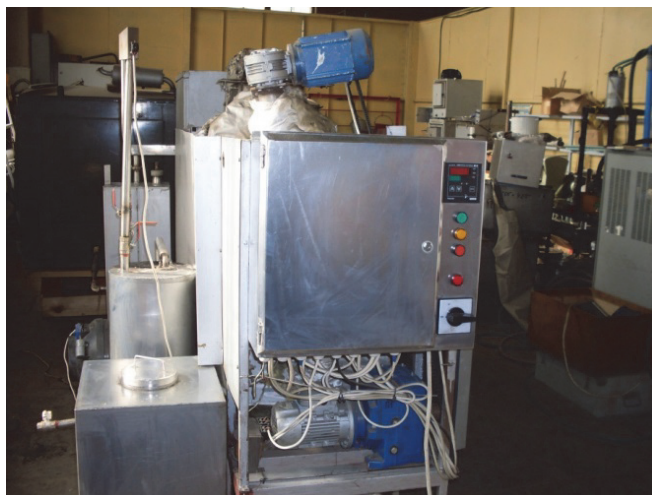
Рис.1 Общий вид пиролизной установки конструкции ФГБНУ ВИЭСХ и Экспериментального завода «Александровский»
