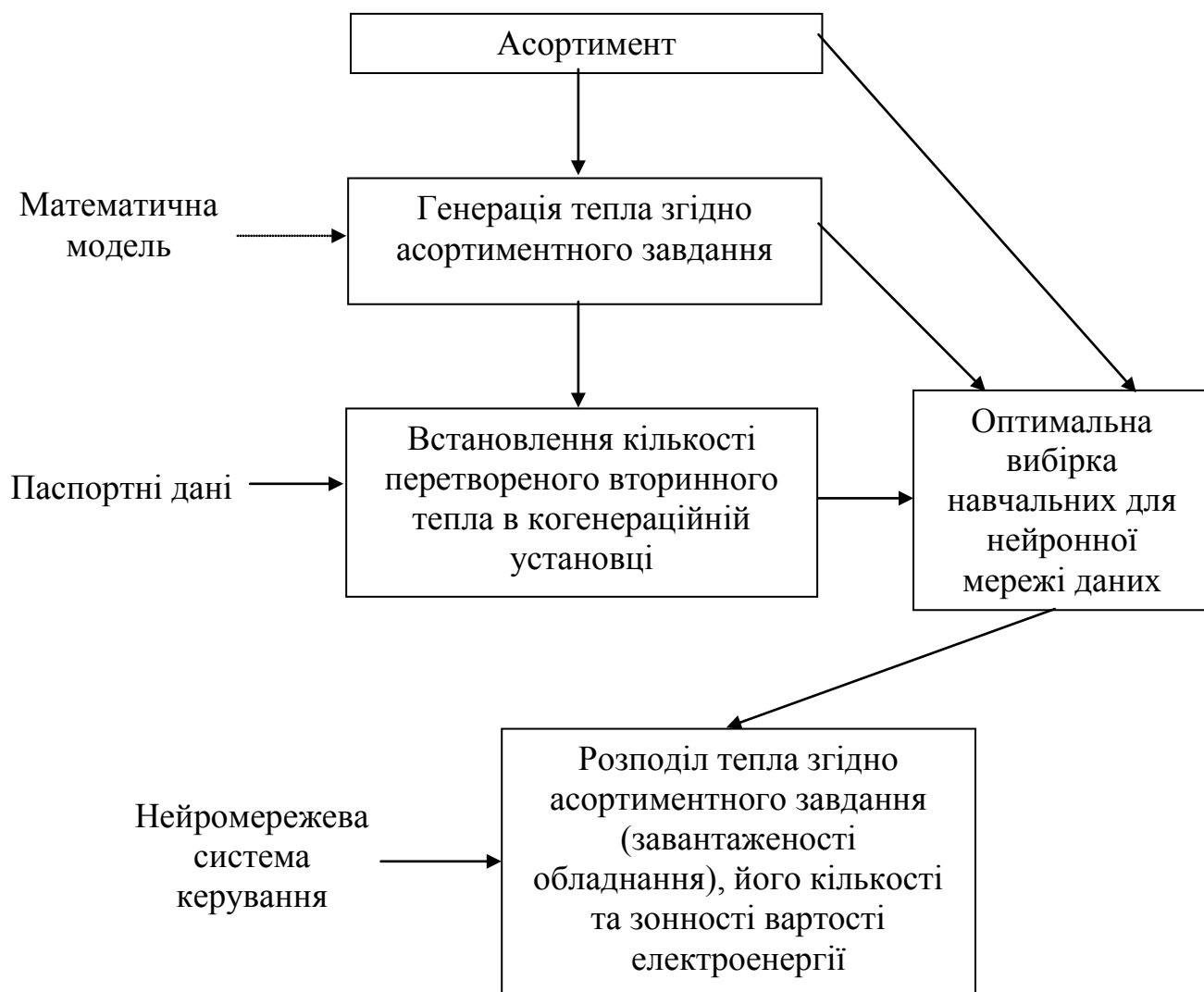
Рис. 3. Концепція енергоефективного керування процесом випічки хліба
