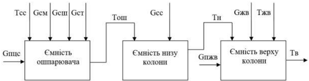
Рис.1. Параметрична схема основних теплових процесів в дифузійній станції:
