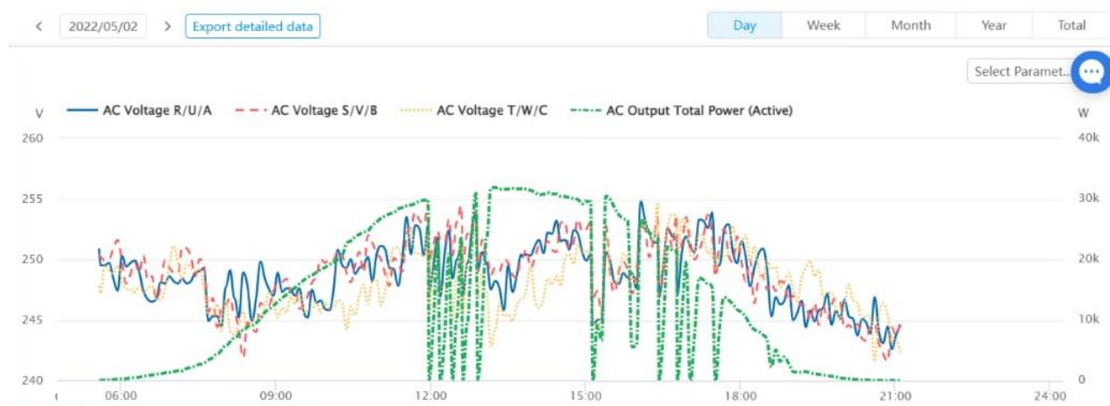
Рис.3. Графік з системи моніторингу ФЕС 30 кВт, з наявними відхиленнями напруги мережі
