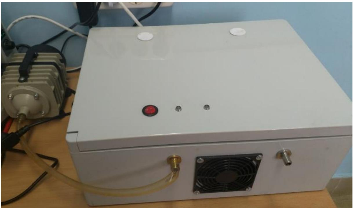
**Рис. 1. Озонатор для очистки сточных вод**
