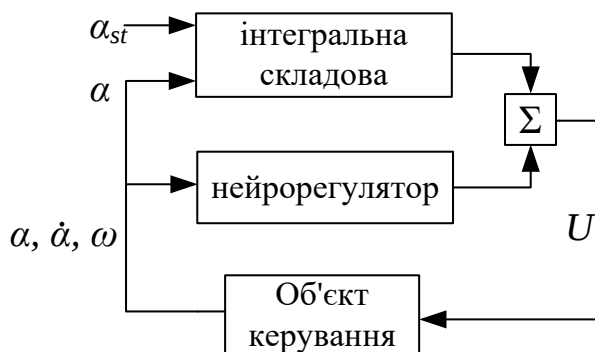
Рис. 5. Зв'язки між об'єктом керування, нейрорегулятором та інтегральною складовою регулятора
