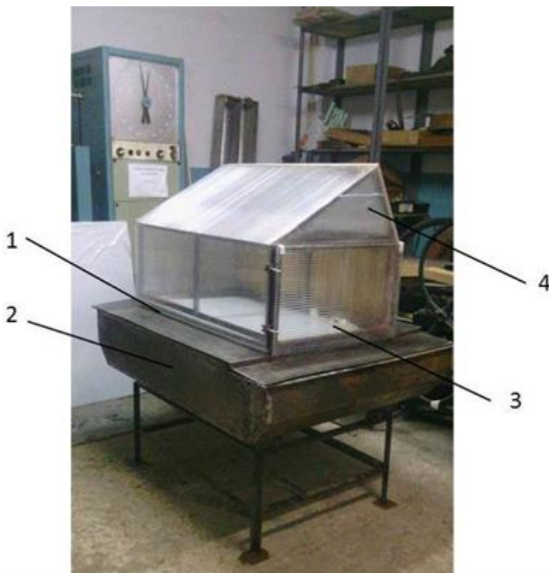
Рис. 2. Експериментальна установка комбінованого сушіння мулових відкладень:
