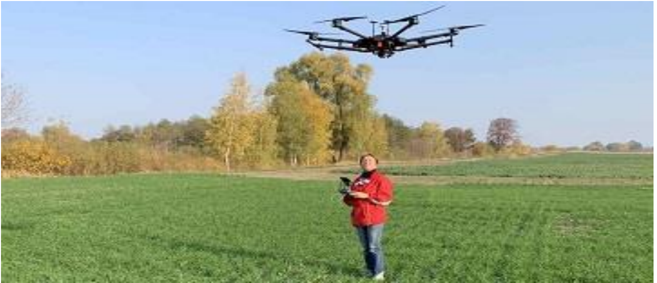
Рис. 2. Система Slantrane 3p, змонтована на базі БПЛА DJI Matrice 600 Pro
