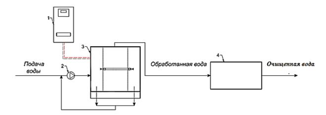
Рис. 6. Упрощённая структура блока безреагентной очистки промышленных сточных вод на основе электролизных процессов с одним электротехническим модулем:
