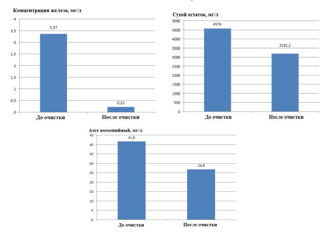
Рис. 2. Результаты очистки сточных вод производства желатиновой продукции БМ на основе электролизных процессов
