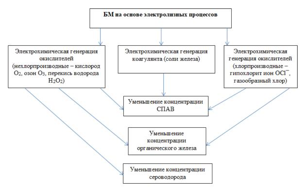
Рис. 1. Структура воздействия электролизно-сгенерированных окислителей и коагулянтов на поллютанты при реализации БМ водоочистки на исследуеммых объектах
