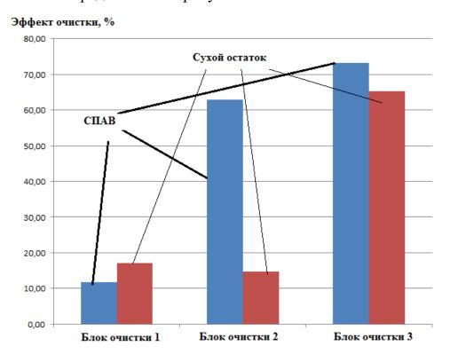
Рис. 4. Редукция загрязнителей разными Блоками
