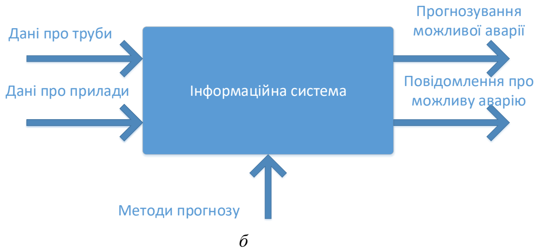
Рис. 2. Структура програми (а), контекстна діаграма потоків даних (б)
