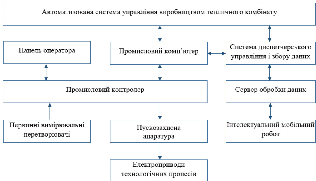
Рис. 2. Схема системи автоматизованого керування енергетичними потоками промислової теплиці
