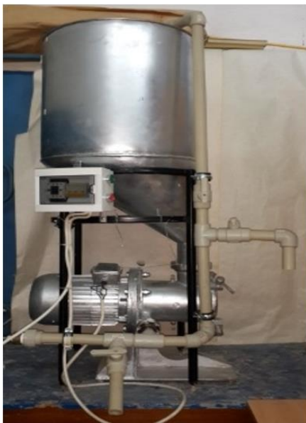
Рис. 1. Загальна вигляд (а) і схема (б) роторно-пульсаційної установки
