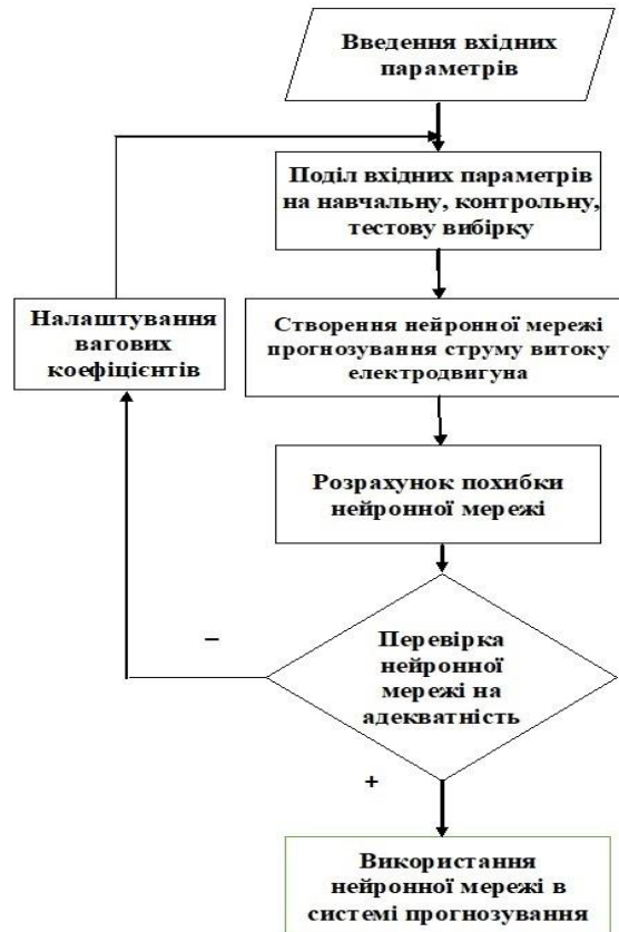
Рис. 1. Алгоритм створення нейронної мережі для прогнозування струму витоку електродвигуна
