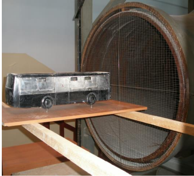
Рис. 1. Порожниста модель автобуса в аеродинамічній трубі
