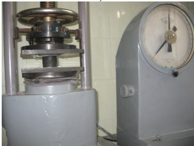
Рис. 4. Процес виявлення фізико-механічних властивостей зразків ОМС з різним вмістом заміника мінерального порошка:
