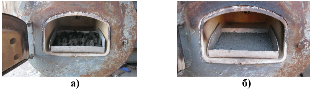
Рис. 2. а) Осад, витриманий 3-4 місяців на муловому майданчику та б) осад термічно оброблений у муфельній печі
