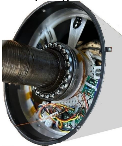
Рис.3. Розміщення вузлів бездротового внутрішнього моніторингу в експериментальному зразку ЗПЕП потужністю 1,5 кВт
