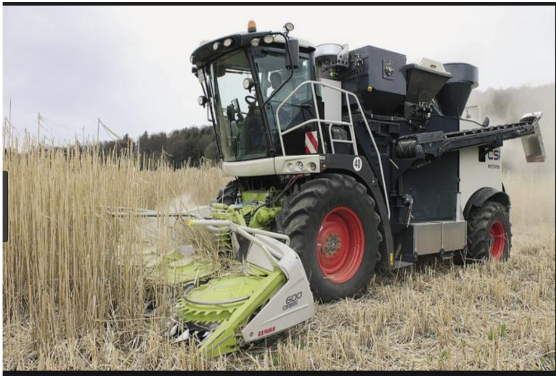
Рис. 1. Скошування, збирання та гранулювання соломи за допомогою комбайну Metitron
