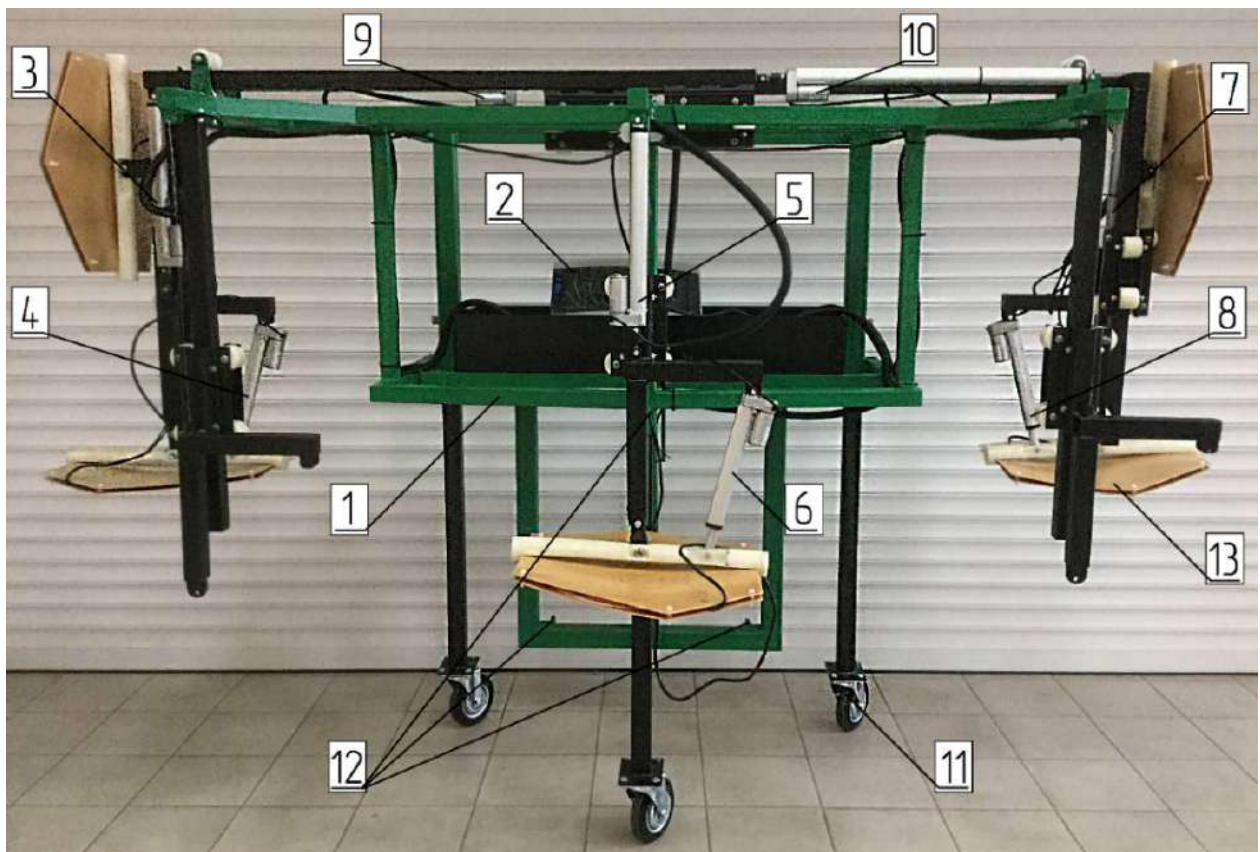
Рис. 1. Автоматизированный агрегат для магнитно-импульсной обработки растений:
