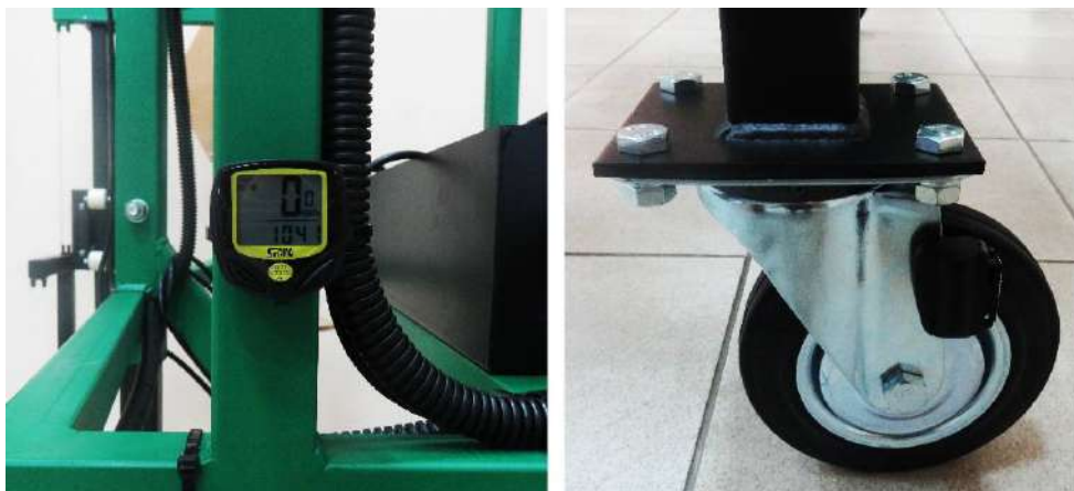
Рис. 4. Дисплей спидометра и крепления датчика к съемным колесам агрегата
