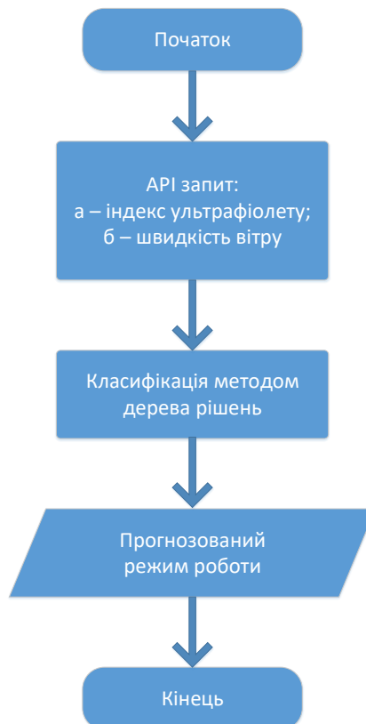
Рис. 3. Узагальнив схему алгоритму для визначення рекомендованого режиму роботи
