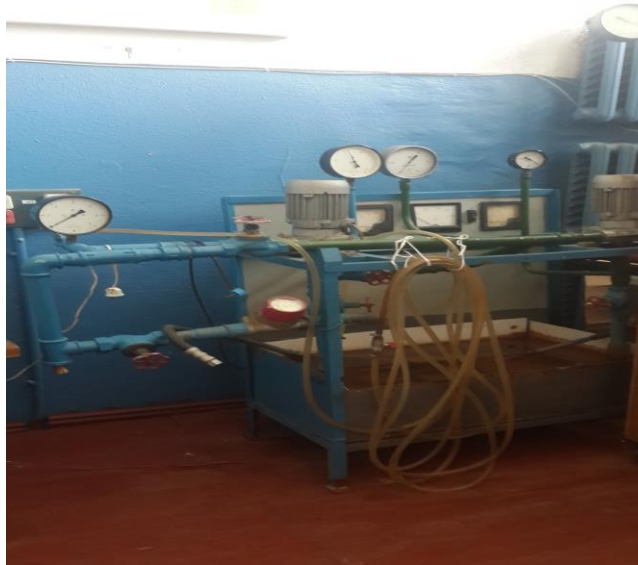
Рис 1. Експериментальний стенд із замкненою циркуляцією рідини для енергетичних випробувань побутових відцентрових насосів
