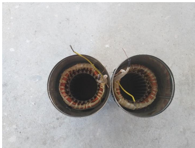
Рис. 6. Однофазні статори БЦПЕ 0,5-40У, 720 Вт
