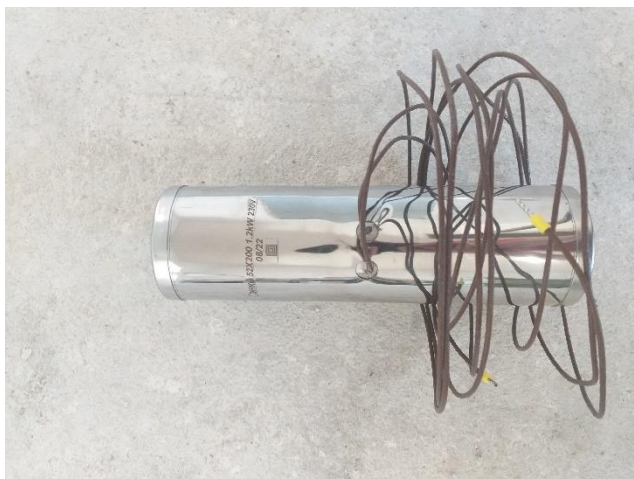
Рис. 4. Кільцевий міканітовий ЕНКм 52х200, 1,2 кВт, 230В
