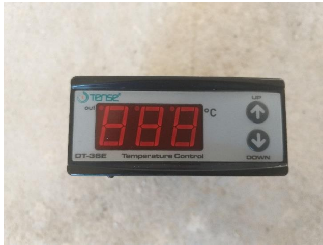
Рис. 5. Цифровий термостат TENSE DT-36E, 0-600 °C
