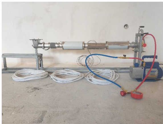
Рис. 1. Шнековий електромеханічний гідролізер
