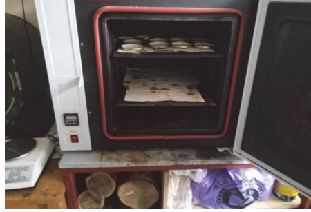
Рис. 4. Розміщення зразків зі смолою у сушильний шафі
