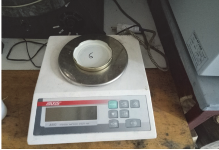
Рис. 3. Зразок смоли КФ-МТ під час процедури зважування початкової маси
