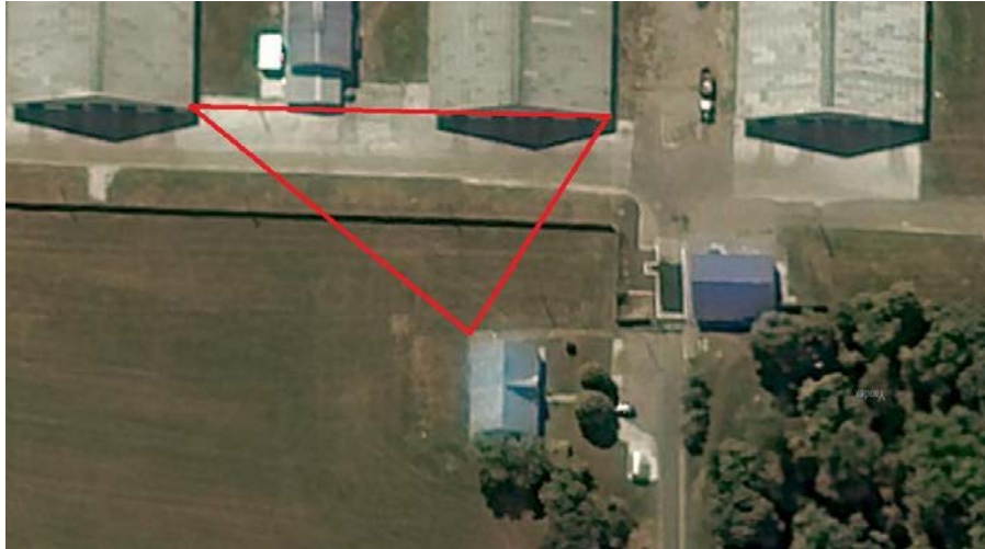
Рис. 3. Прив'язка до місцевості знімків з БПЛА по опорних точках.
