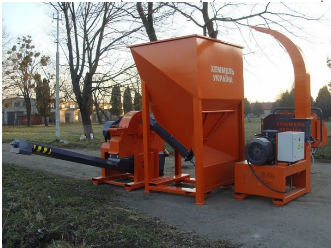
Рис. 2. Лінія подрібнення сухих шматкових відходів RK 847 [6].
