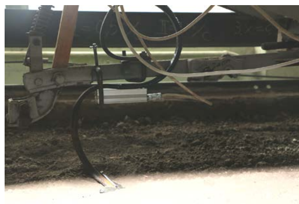
Рис. 2. Загальний вигляд ґрунтового каналу: 1 – пересувний візок; 2 – робочий орган, що досліджується; 3 – канат; 4 – ґрунтове середовище; 5 – тягова лебідка.
