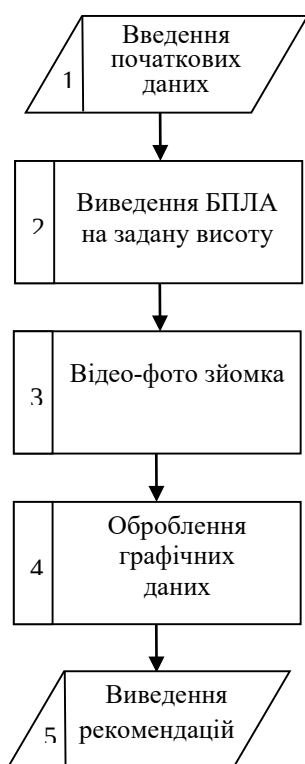
Рис. 5. Алгоритм визначення картограм урожайності за даними з БПЛА.
