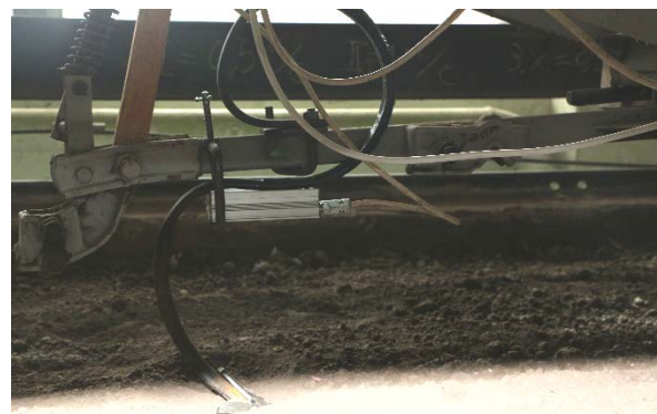
Рис. 2. Загальний вигляд ґрунтового каналу: 1 – пересувний візок; 2 – робочий орган, що досліджується; 3 – канат; 4 – ґрунтове середовище; 5 – тягова лебідка.
