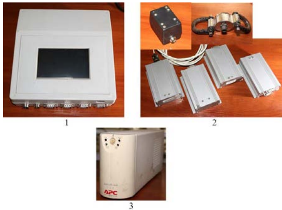
Рис. 4. Загальний вигляд вимірювальної системи та датчиків: 1 – обчислювальний модуль; 2 – датчики; 3 – блок живлення.
