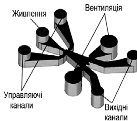
Рис. 2. Тривимірна модель силового струминного елемента (джерело: розроблено в [3], с. 926).
