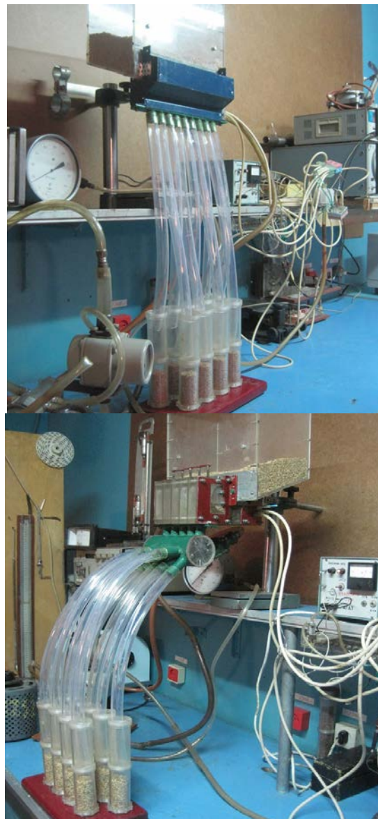
Рис. 1. Загальний вигляд висівних пристроїв на основі пневмоструминних елементів (джерело: розроблено авторами).
