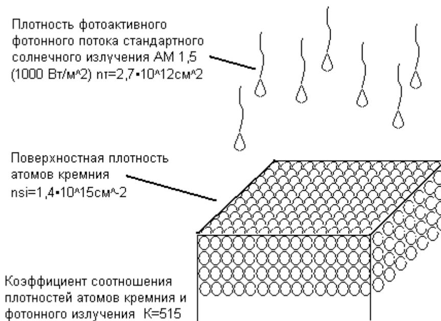
**Рис. 1. Расчётные данные соотношения поверхностных плотностей атомов кремния фотопреобразователя и фотоактивного для него фотонного потока стандартного солнечного излучения AM 1,5 ( $1000 \text{ Вт/м}^2$ ) за время жизни  $\tau = 10$  мкс неосновных носителей зарядов (величина  $\tau$  характерна для кремния солнечного качества ( $S = 1 \text{ см}^2$ )).**
