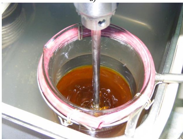
Рис. 5. Нейтралізація МЕЖК при перемішуванні з частотою обертання валу мішалки: а – 200 об./хв.; б – 350 об./хв.; с – 500 об./хв.; д – 650 об./хв.
