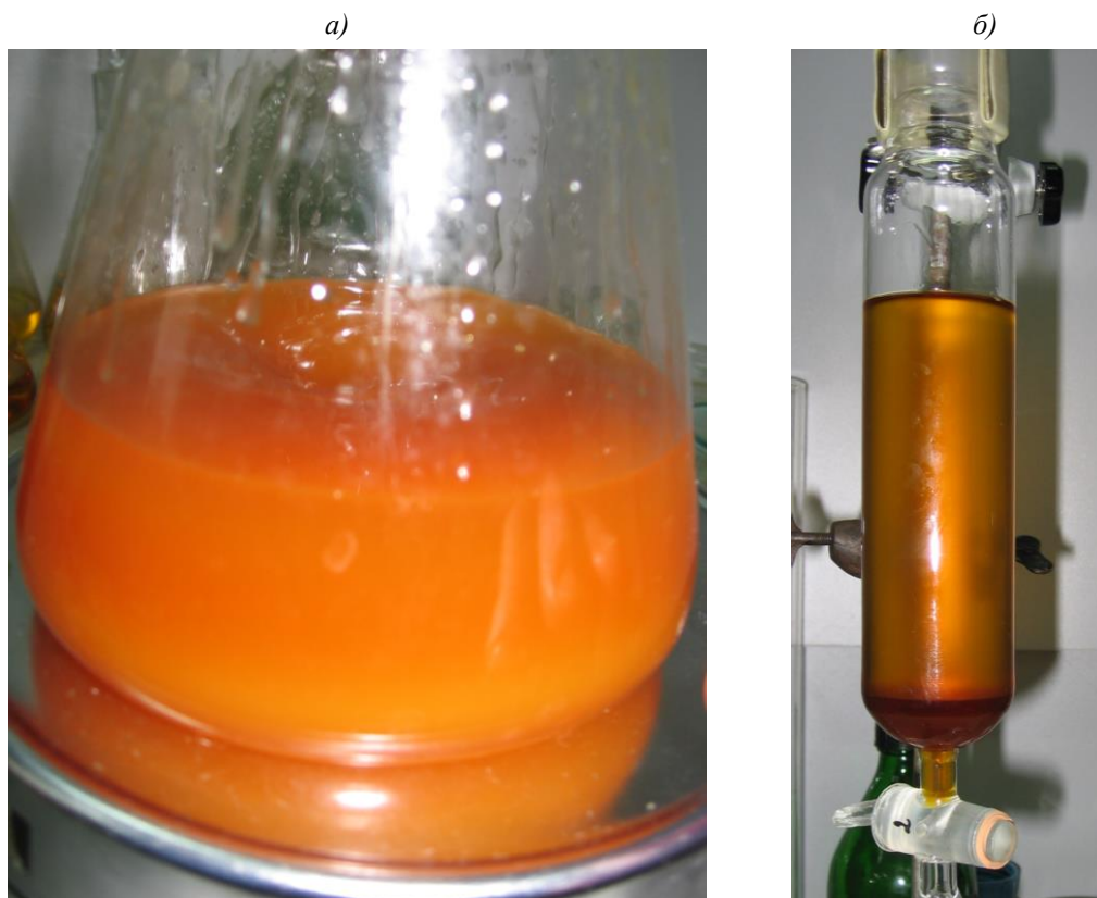
Рис. 1. Виготовлення МЕЖК: а – перемішування реагентів на магнітній мішалці; б – розділення продуктів реакції на метиловий ефір і сирий гліцерин.
