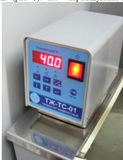
Рис. 4. Виставлення температури 40°C на рідинному термостаті ТЖ-ТС-01/16.
