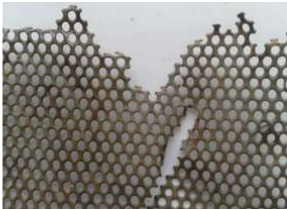
Рис. 2. Пробите решето зернодробарки.
