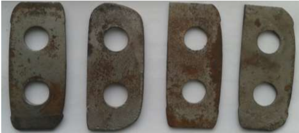
Рис. 3. Спрацьовані молотки кормодробарки.
