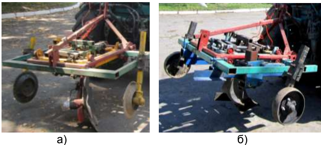
Рис. 8. Пристрій для просторового динамометрування з дисковим робочим органом (а) та корпусом плуга (б).
