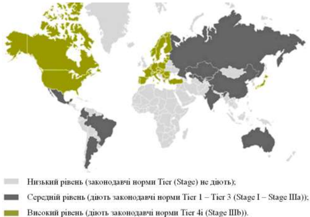
Рис. 1. Карта введення в дію законодавчих норм токсичності і димності ВГ дизелів позашляхових самохідних машин станом на 1 січня 2012 р.
