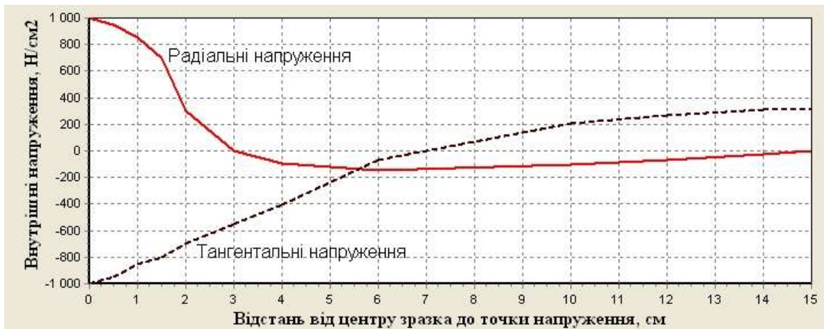
Рис. 6. Залежності ( \sigma_r = f(x_i) , \sigma_t = f(x_i) ) внутрішніх напружень \sigma_r та \sigma_t від відстані x_i точки напруження від центру зразка деревини (при фіксованих: W_{\text{ц}} = 15 см; W_{\text{п}} = 12 см; E_r = 50000 Н/см 2 ; k_r = 0,2 ; k_\theta = 0,3 ).
