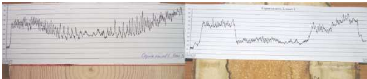
Рис. 2. Изменение мощности на микросверление по диаметру лесоматериала сосны (слева) и диаметру лесоматериала осины с ядровой стволовой гнилью (справа).
