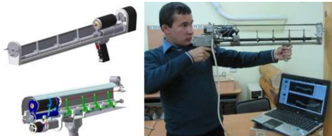
Рис. 1. Модели мобильных устройств для измерения сопротивления сверлению (диагностики состояния древесины), патенты РФ №95128, №2448811 (слева); лабораторная экспериментальная установка для диагностики состояния древесины сверлением (справа).
