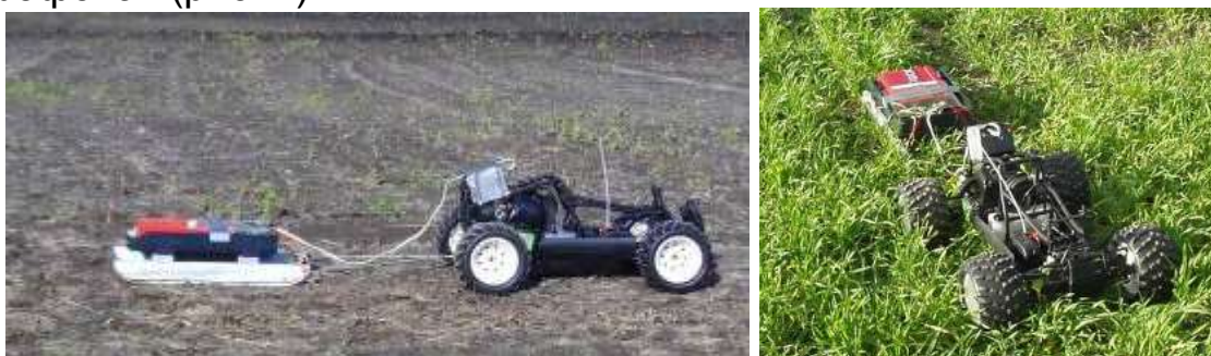
Рис. 7. Мобільний пристрій для визначення електропровідних властивостей ґрунту сенсорним методом.
