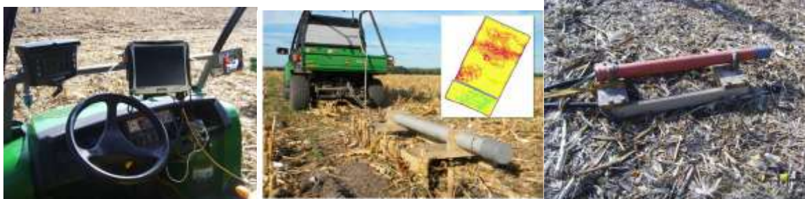
Рис. 6. Пристрій для визначення електропровідних властивостей ґрунту сенсорним методом.
