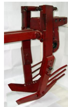
Рис. 4. Загальний вигляд вібраційного викопуючого робочого органу
